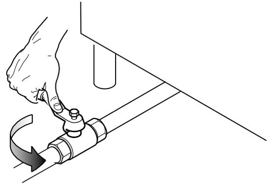
4. Pulire le condutture di allacciamento da polvere, sporcizia, materiali estranei che potrebbero ostruire l'alimentazione. La linea di alimentazione del gas deve assicurare la portata necessaria al pieno funzionamento di tutte le apparecchiature collegate alla rete stessa. Una linea di alimentazione con portata non sufficiente pregiudica il corretto funzionamento delle apparecchiature ad essa collegata.
